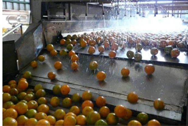
**Oben:** In den Saftfabriken werden die Orangen sortiert, gewaschen und anschließend in eine Pressmaschine gegeben.
